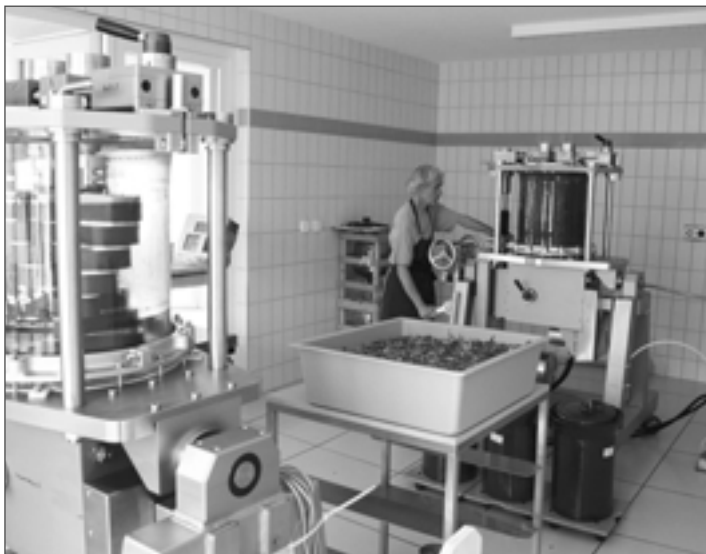
Abbildung 1: Das Herzstück der CERES-Produktion: die Mörsermühle Die Mörsermühle im Extraktionslabor der CERES Heilmittel AG (links) sowie Detailaufnahme (oben).
